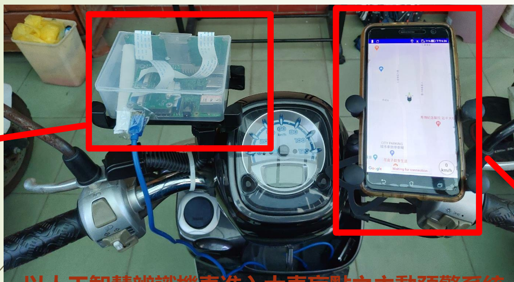
以人工智慧辨識機車進入大車盲點之主動預警系統
