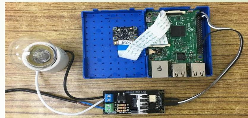
以樹莓派開發板製作的“可攜式心電照護系統”及“IOT智慧照明燈具組”
